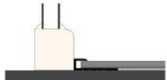
Patio Door Edge to LVT
